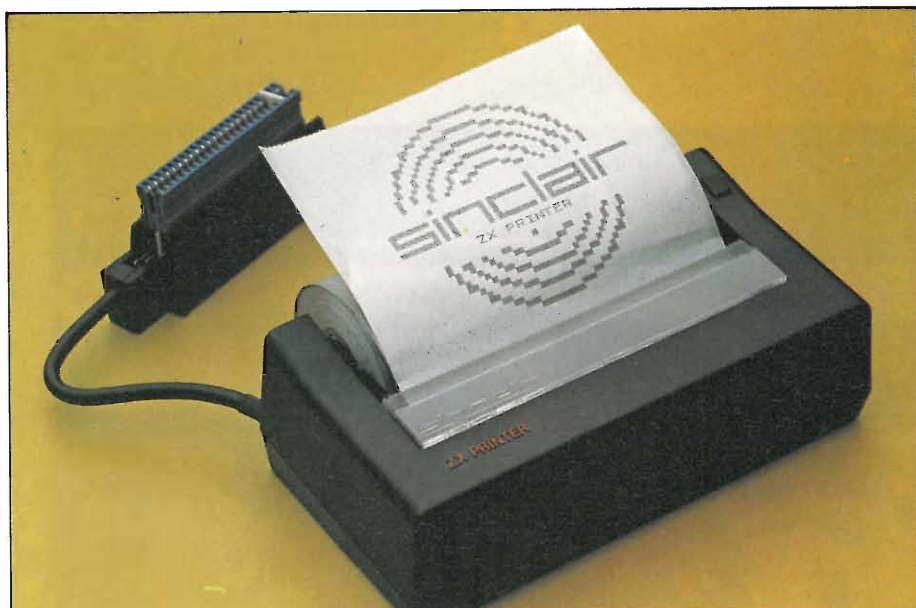
La stampante SINCLAIR scrive su carta metallizzata ed è dotata di un connettore separato da inserire sul retro del microcomputer.
