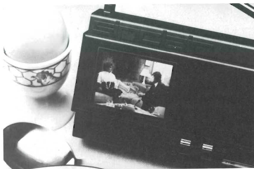
Il nuovissimo televisore a schermo piatto della Sinclair che non ha mancato di stupire tutti gli addetti ai lavori. Con uno schermo di soli 2" e dimensioni ridottissime, questo apparecchio è in grado di ricevere i segnali televisivi nei diversi standard di trasmissione europei ed americani sia in banda UHF sia in banda VHF.
